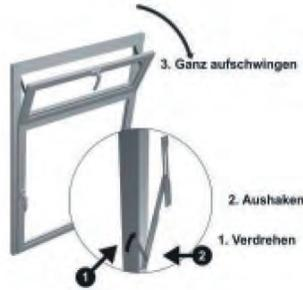
Kippflügel öffnen; den geöffneten Flügel abstützen und den Sicherungsnocken (1) verdrehen. Den Hauptarm (2) aushängen und den Flügel langsam ganz aufdrehen.
