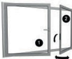
**Achtung:** Bedarfsflügel muss zuerst geschlossen und verriegelt werden, bevor der Gebrauchsflügel geschlossen wird, sonst besteht die Gefahr, dass die Entriegelungstaste beschädigt wird.
