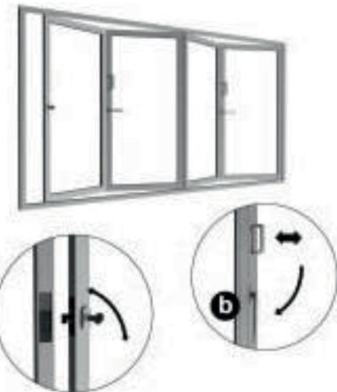
Schließen: Flügel an den Griffen in den Elementrahmen ziehen.
